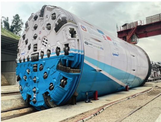
सुरुङ्ग निर्माणको लागि TBM मेसिन जडानको क्रममा
